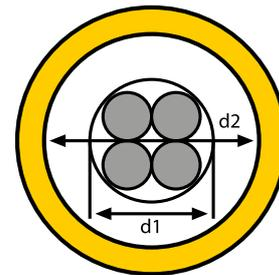
Um Fehlauflösungen zu vermeiden, sollten die Messstromwandler nicht vollständig mit Leitungen ausgefüllt werden. Der Innendurchmesser des Wandlers sollte mindestens doppelt so groß sein wie der Durchmesser des zu messenden Leiterbündels.
