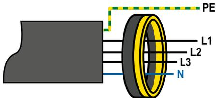
Keine abgeschirmten Leitungen durch den Messstromwandler führen.
