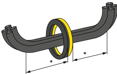
Eine Biegung der Leitung/Leiter darf erst in einem Abstand  $> 30 \text{ cm}^*$  zum Messstromwandler erfolgen.
