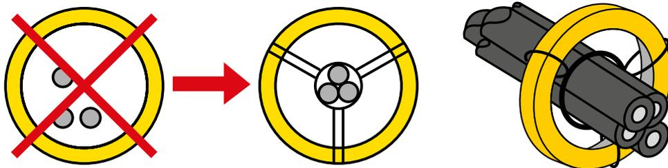
Die Leitungen/Leiter sind in der Mitte des Messstromwandlers zu zentrieren.
