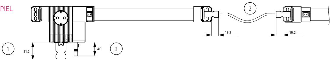
Per Durchgangsverdrahtung können bis zu maximal 8 Leuchten in Reihe geschaltet werden. Zur Eigenkonfektionierung von Leitungen, die von der gelieferten Standardlänge abweichen, sind Buchsen und Stecker zudem separat erhältlich.
