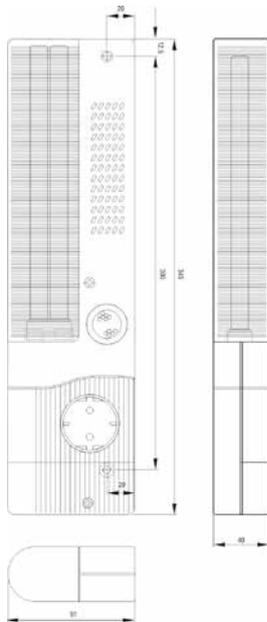
Der Bewegungsschalter schaltet nach dem Öffnen der Schaltschranktür die Beleuchtung ein. Die Einschaltdauer wird bei jeder Bewegung neu gestartet. Die Leuchte kann ebenfalls in Schränken mit Sichtfenster eingesetzt werden.
