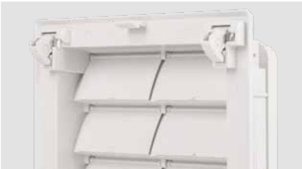
Durch die neue Klappentechnologie entfällt die Filtermatte am Luftauslass, dadurch wird der Luftstrom beim Austritt weniger gehemmt. Es wird so mehr Luft bei gleichem Montageausschnitt ausgetauscht. Dies bedeutet eine effektivere Kühlung für die Anwendung. Ein weiterer Vorteil: Ist der Lüfter nicht in Betrieb, bleiben die Klappen zu und der Schmutz somit draußen.
