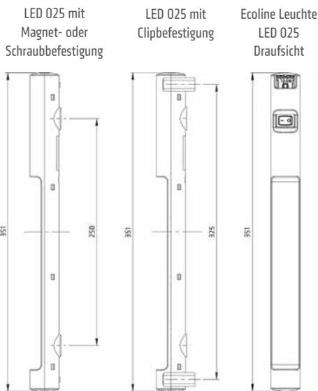
**Befestigungsmöglichkeiten:** Mit der Magnetbefestigung kann die Leuchte ohne Montageaufwand in Stahlschränken befestigt werden. Klassisch ist die LED 025 mit Schraubbefestigung erhältlich. Mit der speziell entwickelten Clipbefestigung kann sie ebenfalls an jede Stelle im Schaltschrank geschraubt werden. Die Leuchte wird lediglich in die Cliphalterung eingerastet und kann in beide Richtungen gedreht werden. Mit einem Gesamtdrehwinkel von 180° wird so eine optimale Ausleuchtung ermöglicht.
