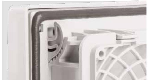
Der Filterlüfter Plus wird von außen in den Schrankausschnitt eingesetzt und werkzeuglos montiert. Durch Betätigen der 6-stufigen Drehriegel wird der Filterlüfter von innen an die Schrankwand herangezogen. Die Drehriegel rasten hörbar ein und geben dem Monteur Rückmeldung, dass das Gerät dicht und stabil sitzt. Die Drehriegelbefestigung ist für Wandstärken von 1 bis 4 mm geeignet.
