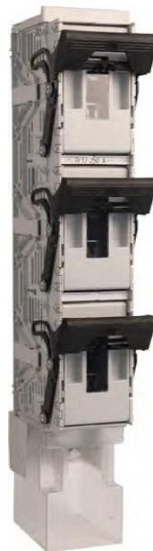
250/400/630/910A LLSB 1 250/400/630/910 185mm 1-polig schaltbar (passend f. Einbaufeld 600mm)
