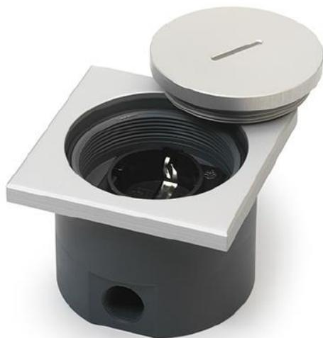
Die Serie 7601 ist mit einem 1 x 230V Steckdose ausgestattet, Möglicherweise ergänzt durch einen zusätzlichen RJ45 Cat6-Datenanschluss. Wenn der Deckel geschlossen ist, ist diese Bodendose wasserdicht IP67. Der einstürzende Teil dieses Bodenkastens ist hergestellt aus Voll-PVC. Der Deckel und die zugehöriges Teil ist aus massivem Aluminium gefertigt ist in Edelstahl-Optik eloxiert. Mit dem mitgelieferten Schlüssel kann die Bodendose geöffnet und geschlossen werden. Wenn der
