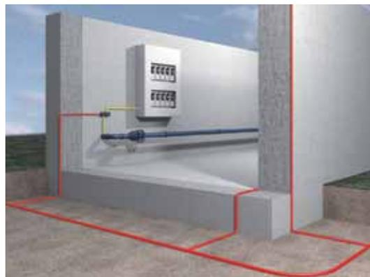
Als Erder muss ein korrosionsbeständiges Material, wie Kupfer oder feuerverzinkter Stahl eingesetzt werden. Dabei beträgt der minimale Querschnitt bei Kupfer 50mm<sup>2</sup> und bei Stahl 75mm<sup>2</sup>. Erder mit rechteckigem Querschnitt müssen mindestens 3mm dick sein.
