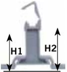
Schienenträger<br>12mm breit aus Polyamid 6.6 grau zum Aufschnappen auf Tragschiene nach EN60715TH35 oder zum Aufschrauben mittels zwei M4-Schrauben geeignet für alle drei Sammelschienen<br>Schienenträger hoch H1 35mm, H2 38mm<br>Schienenträger nieder H1 20mm, H2 23mm | <b>30956</b><br><b>30957</b>               | 158 975 107<br>158 975 007                | <b>30956</b><br><b>30957</b>               | 158 975 107<br>158 975 007                |                |              |
