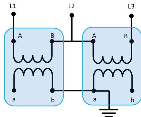
Anschluss von zwei Spannungswandlern VTLD(-L)
