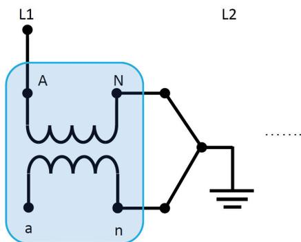
Anschluss eines Spannungswandlers VTLS(-L)
