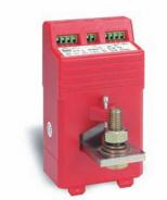
Schiene 40 x 12 mm Rundleiter 27 mm Baubreite 80 mm Bauhöhe 135 mm Bautiefe gesamt 71 mm Gewicht 600 g Eigenverbrauch ≥ 2,5 VA Arbeitsbereich 15 ... 120 % I<sub>N</sub>
