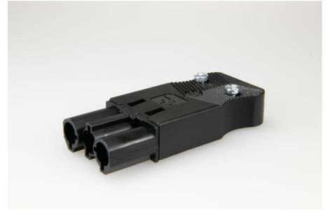
Stecker, 3-polig, schwarz, Codierung: 1 (Netz), Manteldurchmesser min.: 9,5 mm, Manteldurchmesser max.: 10,5 mm, Nennspannung: 250 V, Nennstrom: 20 A, Nennquerschnitt: 2,5 mm<sup>2</sup>, Anschlussart: Schraub
